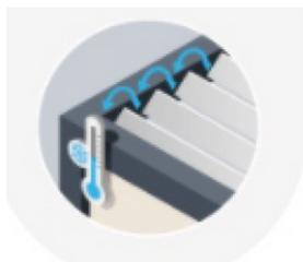
Le LOUVER IO pilote automatiquement d'un léger mouvement les lames pour protéger les joints et assurer leurs mobilités en cas de gel (mode actif à une température de 5°C)
