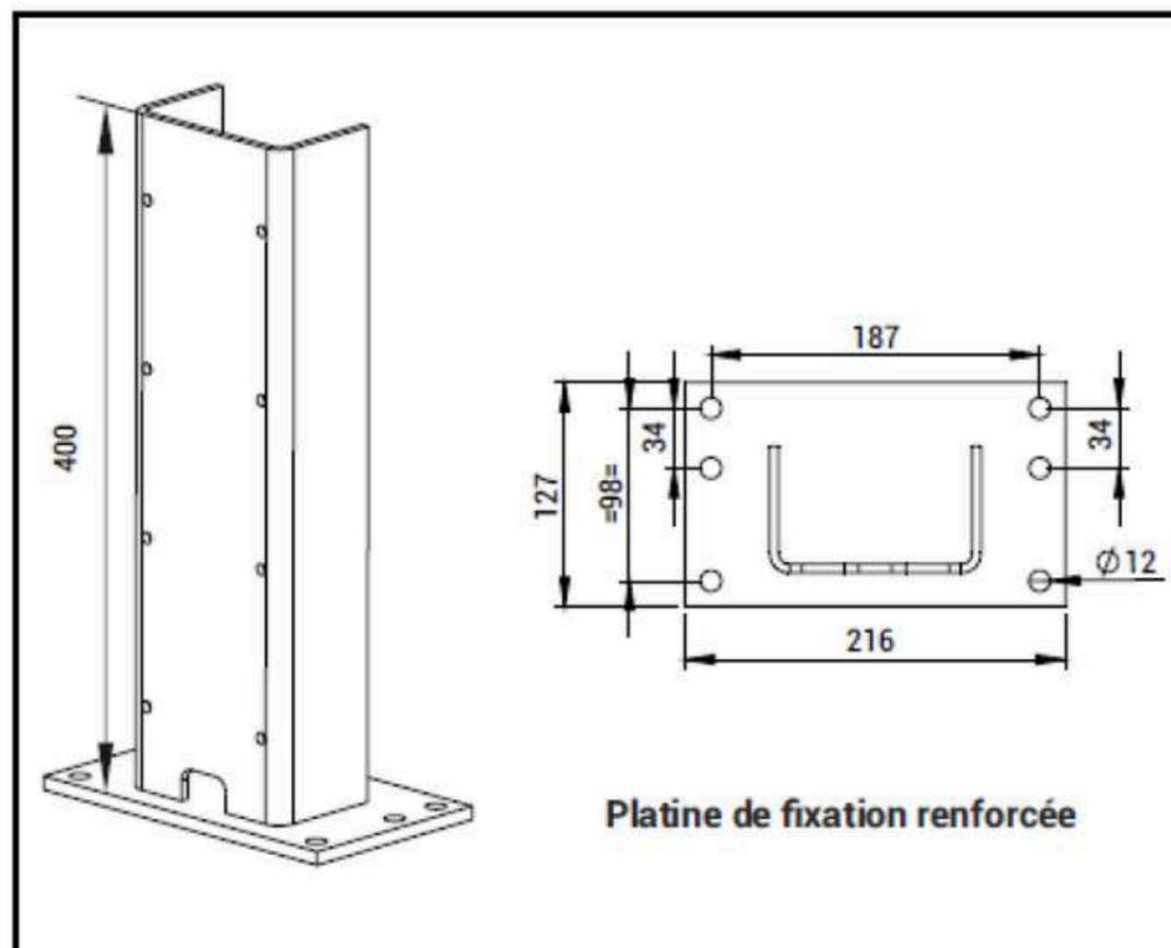
Platine de fixation renforcée
