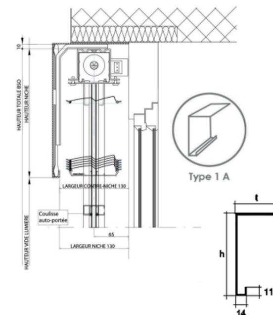
Coupe verticale BSO Z-Line 90 électrique, autoporté, pose tableau, Lambrequin Type 8
