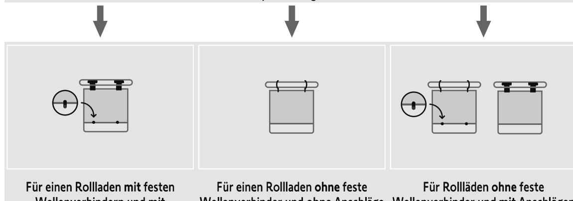
Für einen Rollladen mit festen Wellenverbindern und mit Anschlägen = Plug&Play-Betrieb
