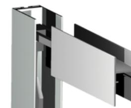
Pour simplifier l'installation et le retrait, un profil latéral spécialement conçu permet une fixation en tableau. Véritable interface entre le mur et la moustiquaire, il corrige les défauts de verticalité et facilite le montage ainsi que le démontage. À l'arrière, un emplacement dédié pour un joint brosse assure une finition soignée et une étanchéité optimale, tout en réduisant l'usage de silicone.
