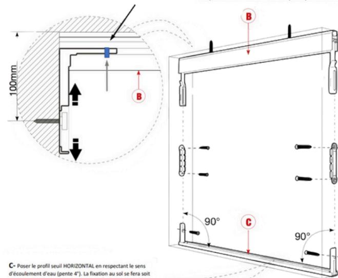
C- Poser le profil seuil HORIZONTAL en respectant le sens d'écoulement d'eau (pente 4°). La fixation au sol se fera soit par vis + cheville soit à l'aide de mastic / colle sans boucher les écoulements d'eau. Cliper les équerres basses dans le profil Seuil en position et visser de chaque côté.
