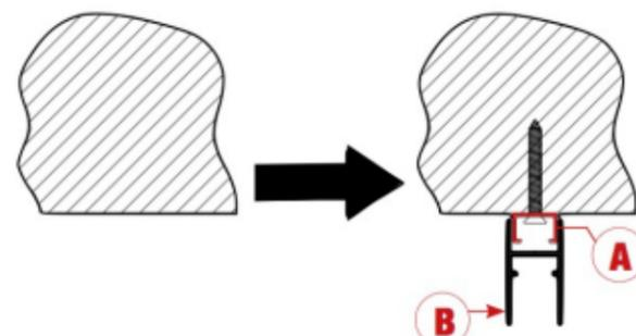
Tracer la verticale à partir du profil Linteau et aligner les perçages des clips et de l'équerre du bas.
