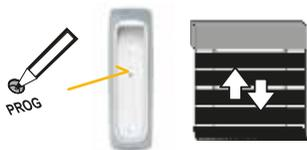
**Faire un appui** bref sur le **bouton PROG** de ce point de commande : le B.S.O. effectue un bref mouvement, le point de commande est enregistré.
