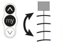
Pour valider le réglage de la course angulaire appuyer en même temps sur les **touches montée et «my»** du point de commande jusqu'au mouvement du B.S.O.
