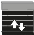
**Appuyer brièvement en même temps** sur les **touches montée et descente**.
