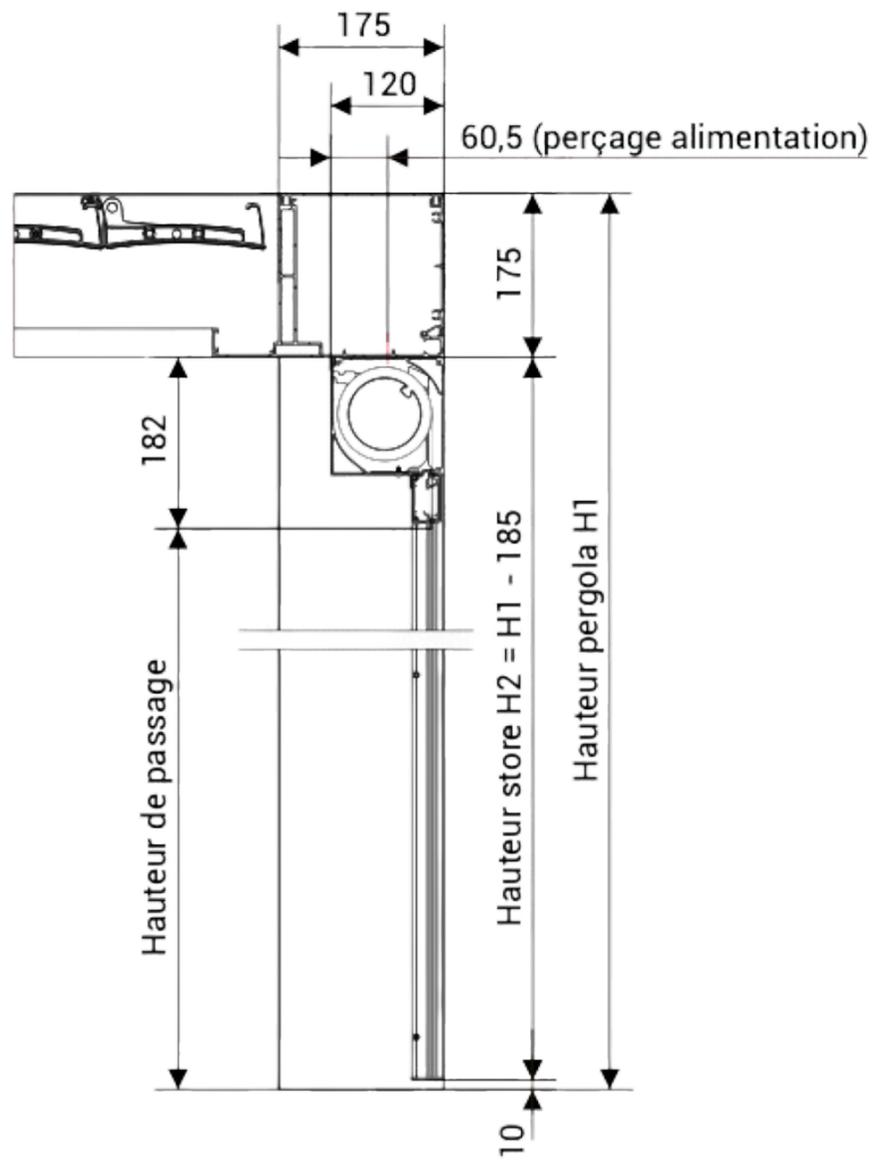
Préconisations de montage : coffre intérieur et coulisses alignées sur l'extérieur des poteaux. Perçage pour l'alimentation sur le dessus recommandé
