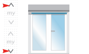
Ajustez la nouvelle position haute
