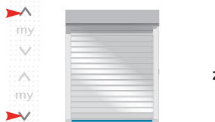
Ajustez la nouvelle position basse
