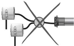
Ne pas brancher 2 inverseurs sur un moteur
