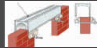
Mise en place du coffre en le centrant dans la baie. L'alignement du coffre se fait par rapport au nu du mur.
