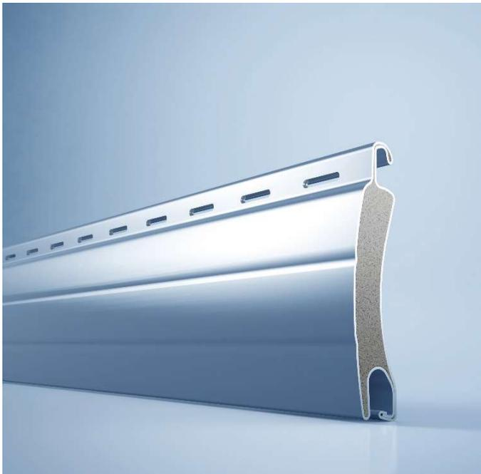
Avec son épaisseur de matériau unique et le remplissage en mousse de moyenne densité, la lame heroyal RS 37 SL, extrêmement stable, est sans concurrence sur le marché. Elle répond ainsi aux exigences de la classe de résistance au vent 4 pour des largeurs d'éléments jusqu'à 3 000 mm ainsi qu'aux directives BVRS (Association fédérale pour les volets roulants et la protection contre le soleil – Bundesverband für Rolladen und Sonnenschutz) TR 111 dans le domaine de la protection anti-effraction.
