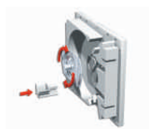
1 Mise en place de la tulipe et plaque support sur joue.
