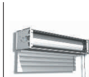
8 Enrouler le tablier dans le caisson en manœuvrant le treuil.
