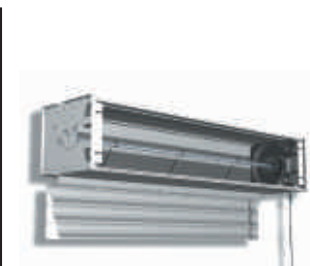
7 Mise en place du tablier. Dérouler le tablier par-dessus l'axe dans les coulisses.
