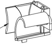
LONGUES RAMPES POUR FACILITER ENGAGEMENT DES AXES-LE FLASQUE SE MONTE D'UN GESTE LE FLASQUE EST ENGAGE SUR LA PATTE: SENS INTERIEUR VERS EXTERIEUR
