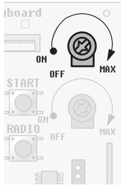
Le préavis souhaité peut être réglé, si nécessaire, avec le potentiomètre 1. Pendant la durée du préavis, l'avertisseur lumineux externe et l'éclairage interne clignotent. Lorsque le potentiomètre est positionné à gauche, la fonction est désactivée.
