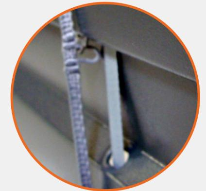
**Des éléments d'assemblage en acier inox** sont disposés entre les lames et les rubans porteurs permettent de remplacer ultérieurement sur place les différentes lames. Les rubans renforcés de fibres d'aramide garantissent une bonne fermeture des lames pendant de nombreuses années.
